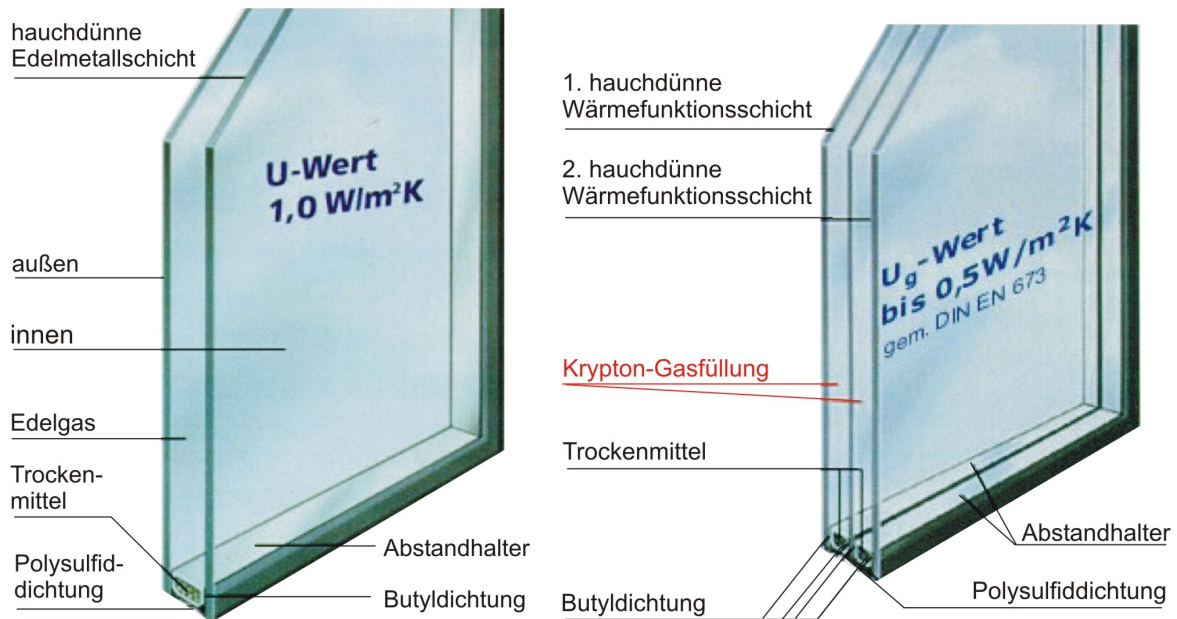
Bild 15: Ausführung von Mehrscheiben-Wärmedämmglas
